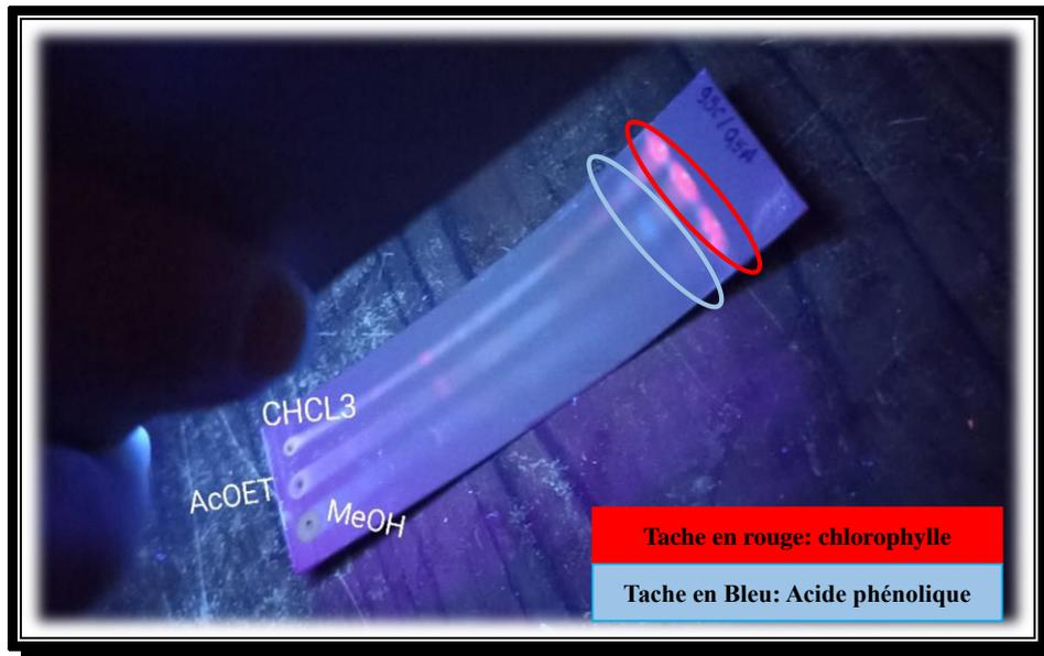
**Figure 28 :** Révélation de la plaque CCM des extraits CHCl<sub>3</sub>, AcOEt et MeOH sous lampe UV 365 nm
